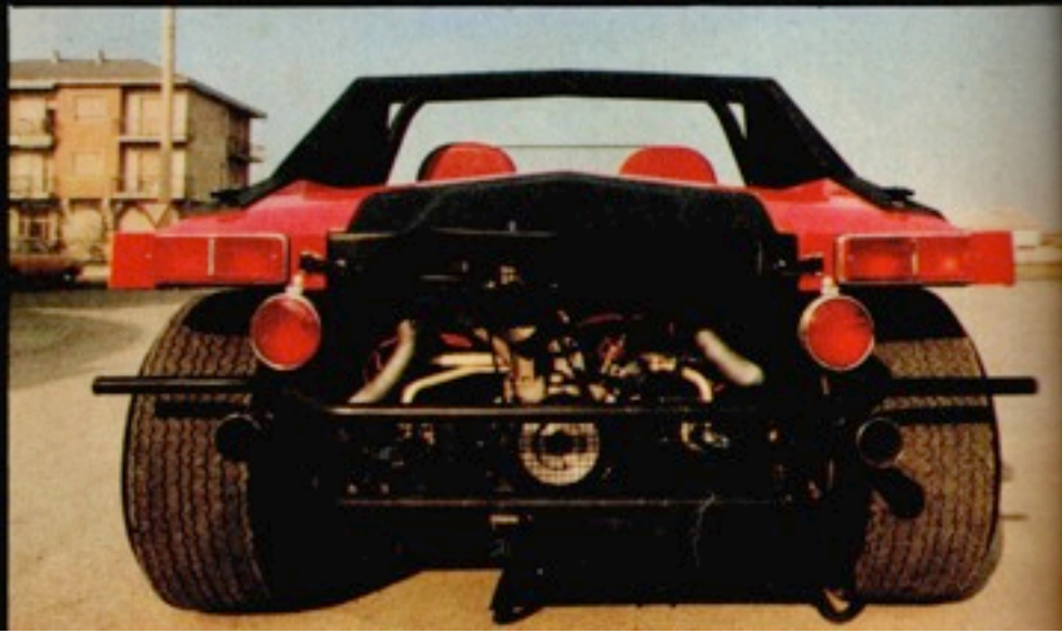
L'« Hot Car » è uno dei modelli che si distinguono per la carezza, la quale non rischia le solite linee che accomunano nello stile molti dune buggies, se ne differenzia anche per il parabrezza ribaltabile e il colano motore asportabile.
