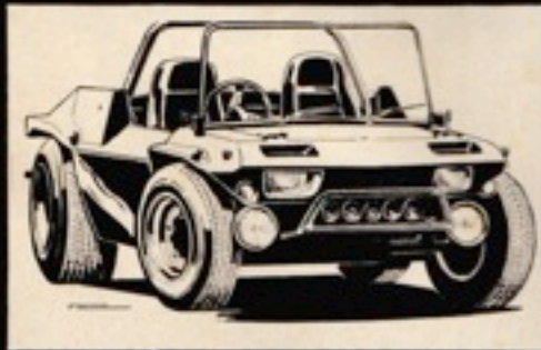
L'« Hot Car » è uno dei modelli che si distinguono per la carezza, la quale non rischia le solite linee che accomunano nello stile molti dune buggies, se ne differenzia anche per il parabrezza ribaltabile e il colano motore asportabile.
