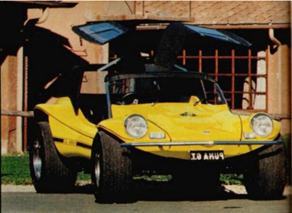
Il nuovo « Puma GT » stilisticamente più moderno, ha il frontale profilato con fari parzialmente incassati e parabrezza più inclinato. Caratteristico è l'hard-top con due portiere incernierate sul tetto, che si aprono ad ala di gabbiano.
