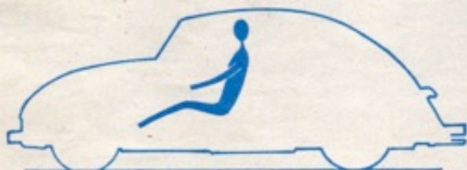
Minime condizioni di peso in esercizio: vettura parzialmente rifornita (metà serbatoio carburante) e solo guidatore: kg 915 dei quali kg 390 (42,6 %) all'avantreno e kg 525 (57,4 %) al retrotreno.
