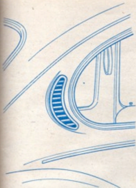
Particolare della feritoia uscita aria dall'abitacolo posta dietro al finestrino laterale posteriore.
