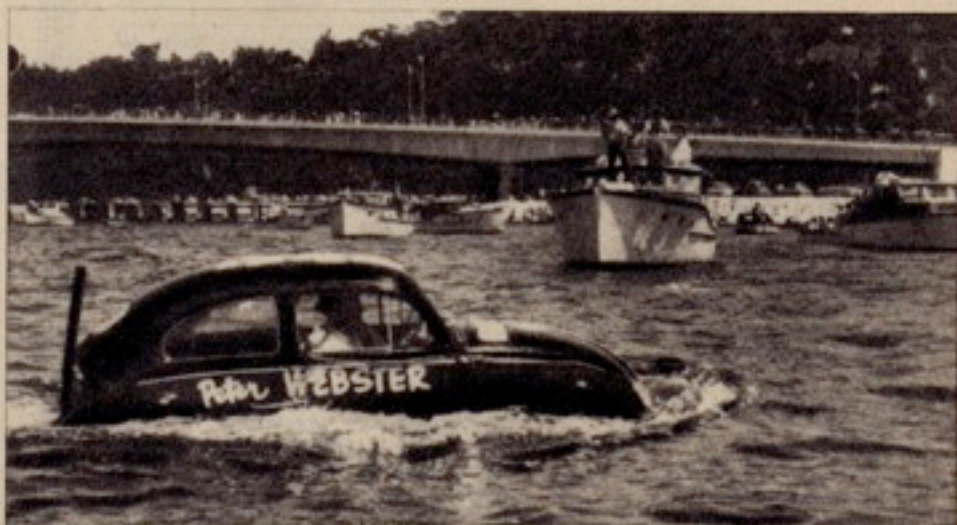
La Volkswagen mentre procede nell'acqua: come si vede la linea di galleggiamento è all'altezza dei fari e in coda si osservano i tubi di scarico verticali. La velocità di crociera di questa Volkswagen marina è di 5 nodi.
